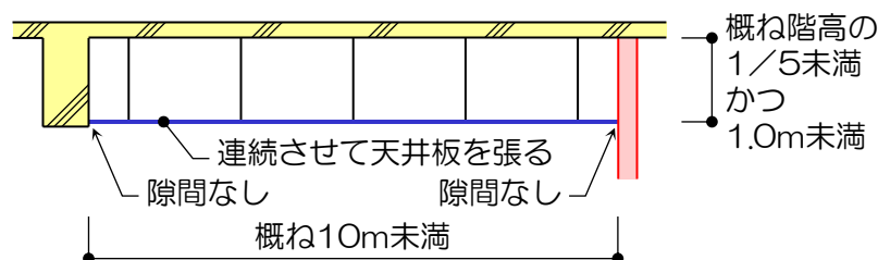
図2-8-12 小規模天井の地震対策の概念図
