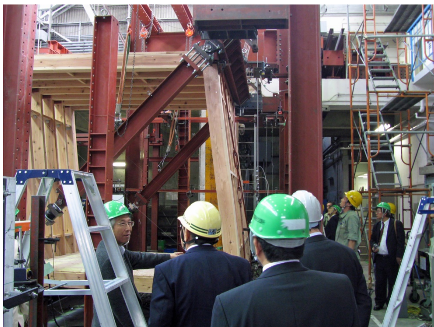
↑耐震シェルターの実大実験にて
